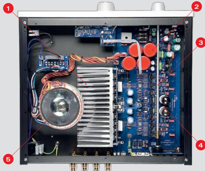
**1** Veliki hladnjak**2** Izlazni kondenzatori**3** Vro dugačak prekidač za izbor ulaza**4** ECC83 cijevi
